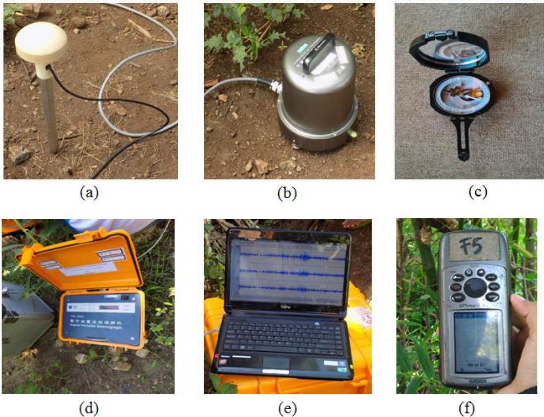
Gambar 14. Peralatan Akuisisi Mikrotremor, yaitu (a) GPS, (b) Seismic sensor , (c) kompas, (d) Digitizer , (e) Laptop, dan (f) GPS portable .
