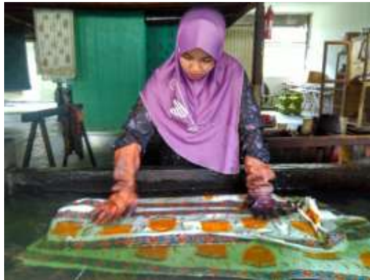
Gambar 92. Proses penguncian warna dengan HCl
