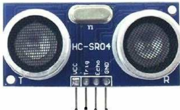
Gambar 9. Konfigurasi Pin HC-SR04
