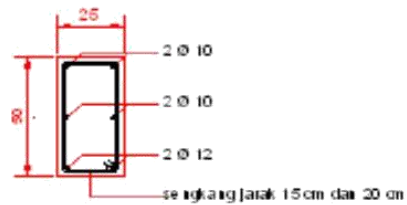
POTONGAN PENULANGAN BALOK A ATAU B
