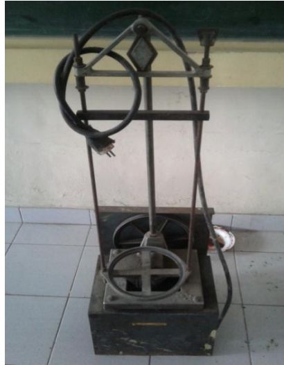
Gambar 15. Mesin Ayakan Pasir
