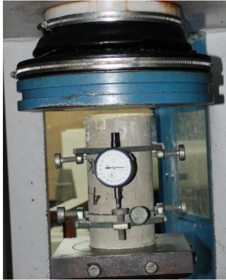
Gambar 43. Pengujian kuat tekan silinder
