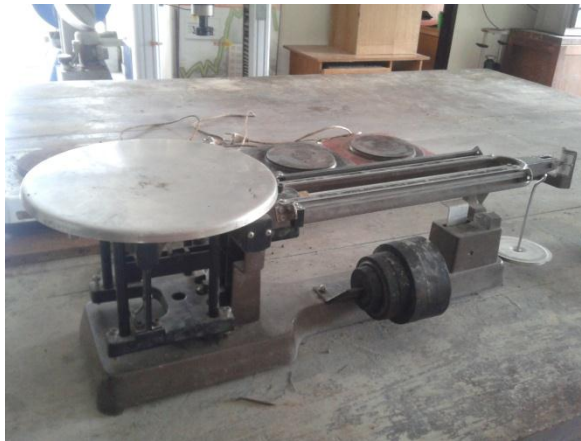
Gambar 18. Timbangan dengan kapasitas 10 kg
