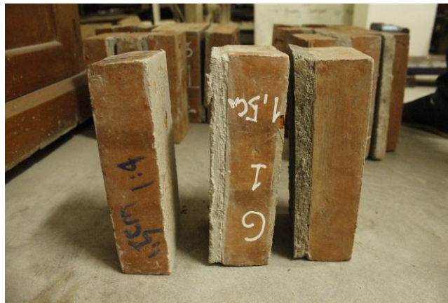
Gambar 59. Benda Uji 1,5GPB C 1PC:3Ps:3Pm
