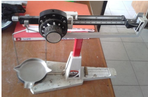
Gambar 17. Timbangan dengan kapasitas 310 gram
