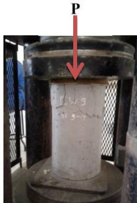
Gambar 44. Metode Pengujian kuat tekan beton
