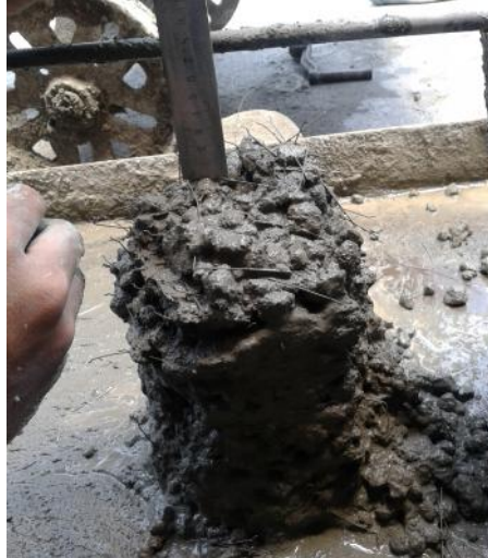
Gambar 43. Metode Pengujian nilai slump
