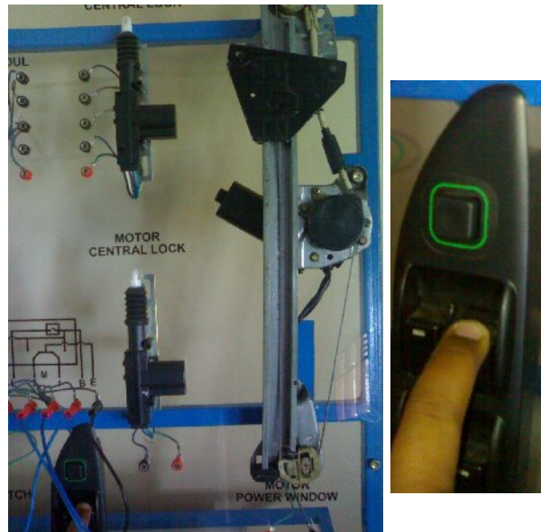
Gambar 32. Hasil Pengujian motor power window dan saklar utama pengemudi pada saat naik
