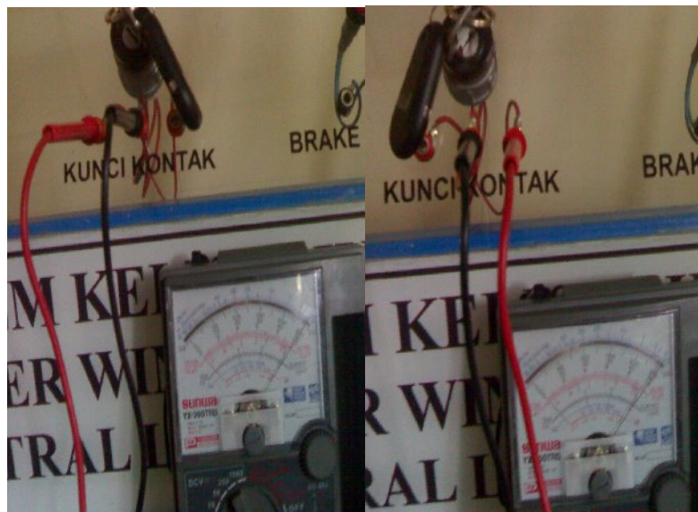
Gambar 29. Pengukuran kontinuitas antar posisi pada kunci kontak
