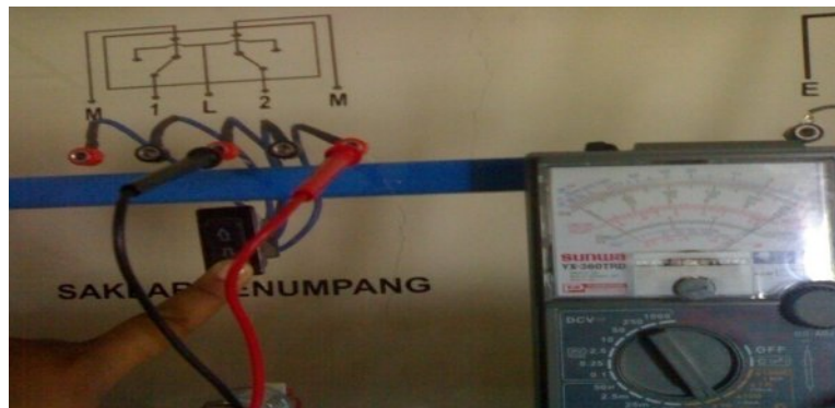
Gambar 43. Hasil pengukuran kontinuitas saklar penumpang pada saat turun
