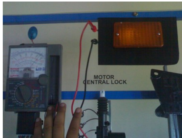
Gambar 45. Hasil pengujian lampu sein
