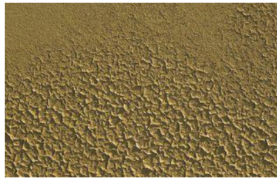
Gambar 23. Mengkerut/terangkat (Anonim, tth-a)
