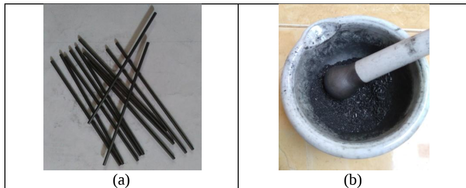
Gambar 11. (a) Batang tri graphite pensil 2B Faber Castell, (b) Batang graphite yang telah dihaluskan menggunakan mortar.
