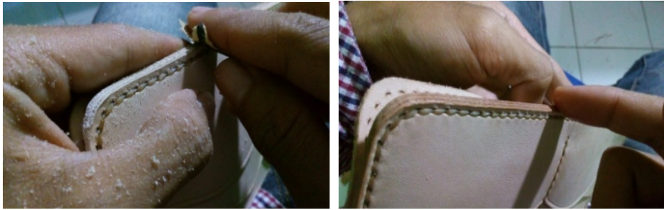
Gambar 68: Proses pengamplasan bagian pinggir (kiri) Proses memberikan burnishing gum (kanan) (Sumber: Dokumentasi Emanuel, Maret 2016)
