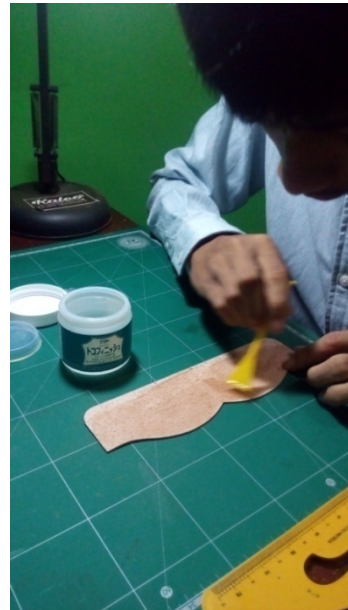
Gambar 61: Proses memotong kulit (kiri) Proses memberi burnishing gum (kanan) (Sumber: Dokumentasi Emanuel, Maret 2016)
