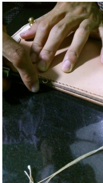
Gambar 67: Merapikan pinggiran menggunakan beveller (Sumber: Dokumentasi Emanuel, Maret 2016)
