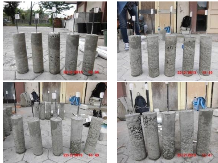
Gambar 40. Pembongkaran silinder benda uji.
