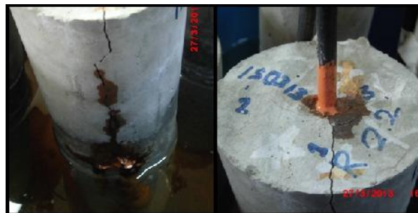
Gambar 66. Pola retak beton dengan agregat kasar recycle 2 .
