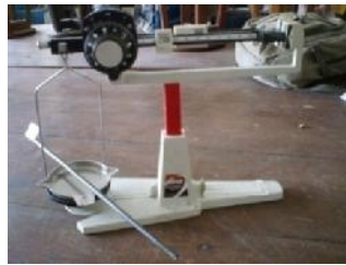
Gambar 44. Menimbang baja tulangan sebelum korosi.
