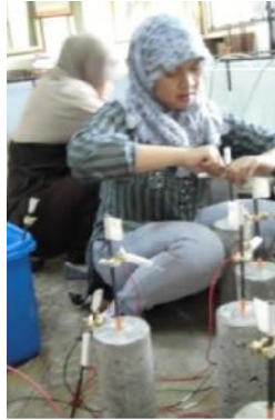
Gambar 46. Pemasangan klem pada beton.
