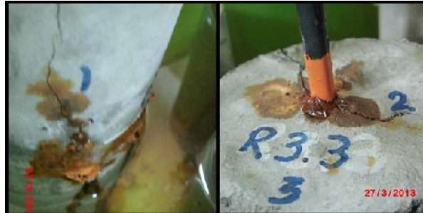
Gambar 67. Pola retak beton dengan agregat kasar recycle 3 .
