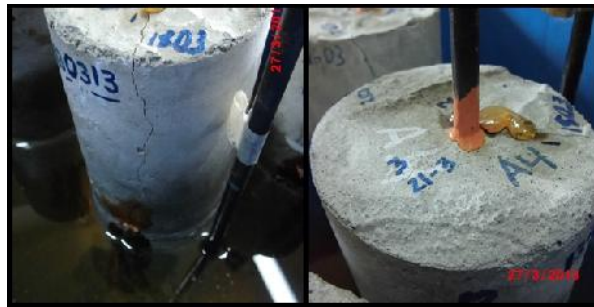
Gambar 64. Pola retak beton dengan agregat kasar asli.
