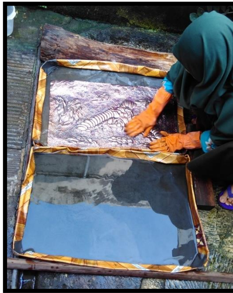
Gambar 42. Perendaman logam dengan larutan HCl
