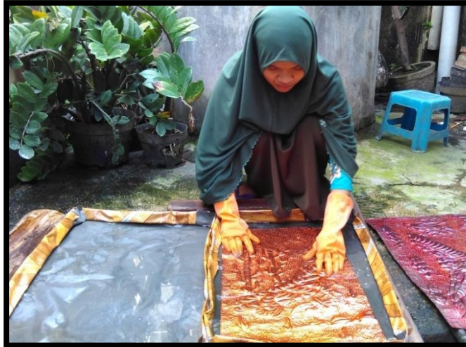
Gambar 40. Perendaman logam tembaga ke dalam larutan SN
