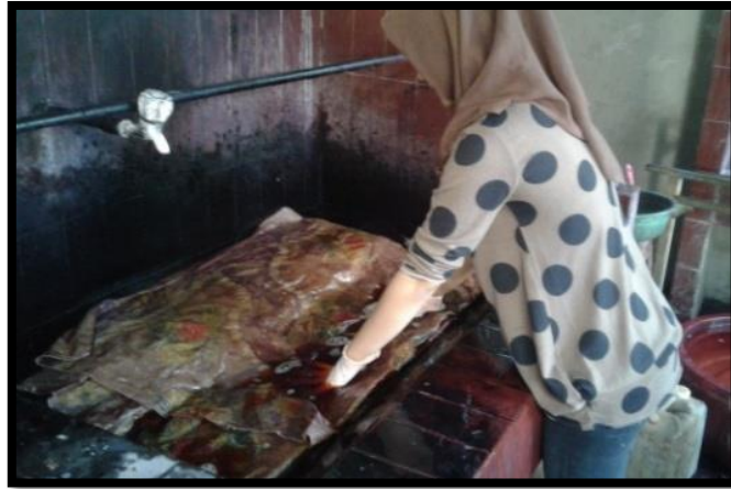
Gambar XXXVII: Pewarnaan celup menggunakan naphtol (Dokumentasi: Diah Ayu Heryamien. 2016)
