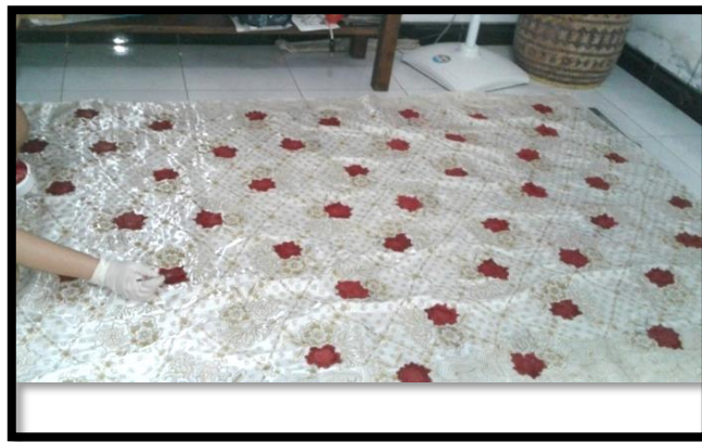
Gambar XXXV: Pewarnaan colet menggunakan rapid merah (Dokumentasi: Diah Ayu Heryamien. 2016)
