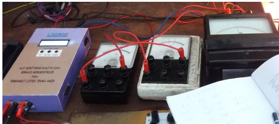
Gambar 47. Pengujian Kalibrasi pengukuran daya dengan Watt Meter
