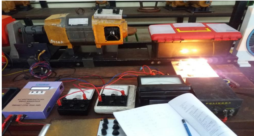
Gambar 44. Pengujian Kalibrasi Alat Monitoring
