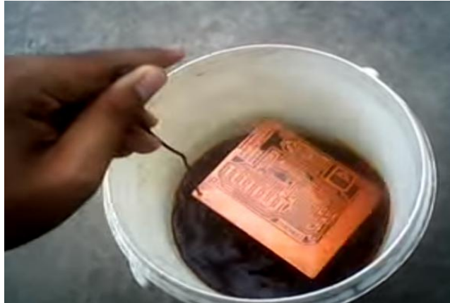
Gambar 32. Proses Pelarutan Pcb
