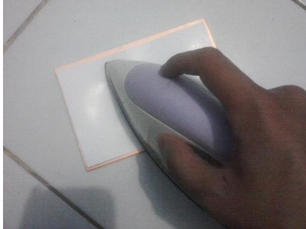
Gambar 31. Proses Penyetrikaan Gambar Rangkaian di Papan Pcb
