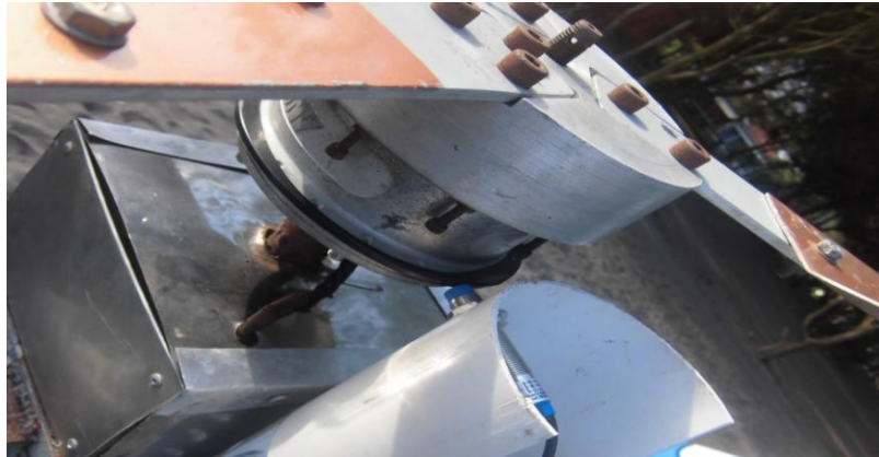
Gambar 48. Penempatan Sensor Proximity di Pembangkit Listrik Tenaga Angin
