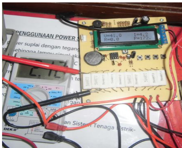
Gambar 43. Pengujian Sensor Arus
