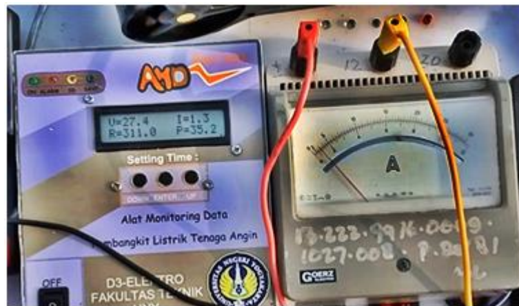
Gambar 46. Pengujian Kalibrasi untuk Pengukuran Arus
