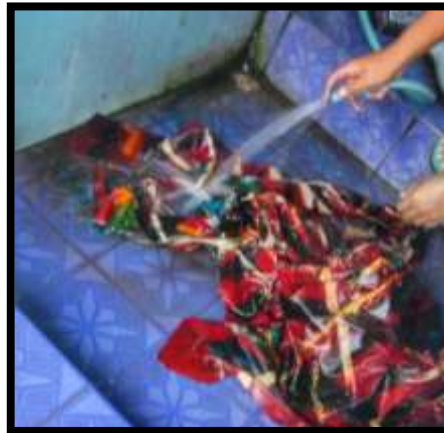
Gambar XXVI: Proses pembilasan kain batik.
