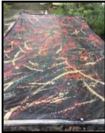
Gambar XXIII: Proses penguncian warna menggunakan waterglass secara merata.
