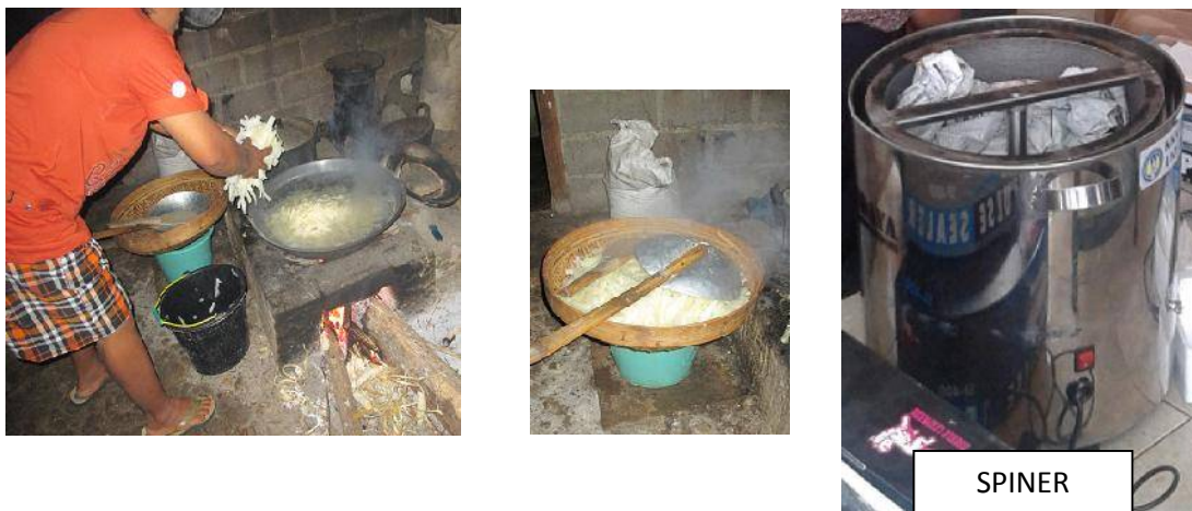
Gambar 5 : Cara penggorengan dan penirisan gorengan sebelumnya dan Mesin SPINER
