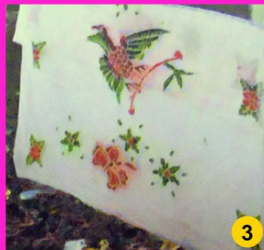
Gambar 35 Pencucian setelah difiksasi dengan waterglass , kain dicuci dengan air bersih.
