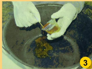
3. Masukkan larutan naphthol yang sudah di beri air panas ke dalam ember
