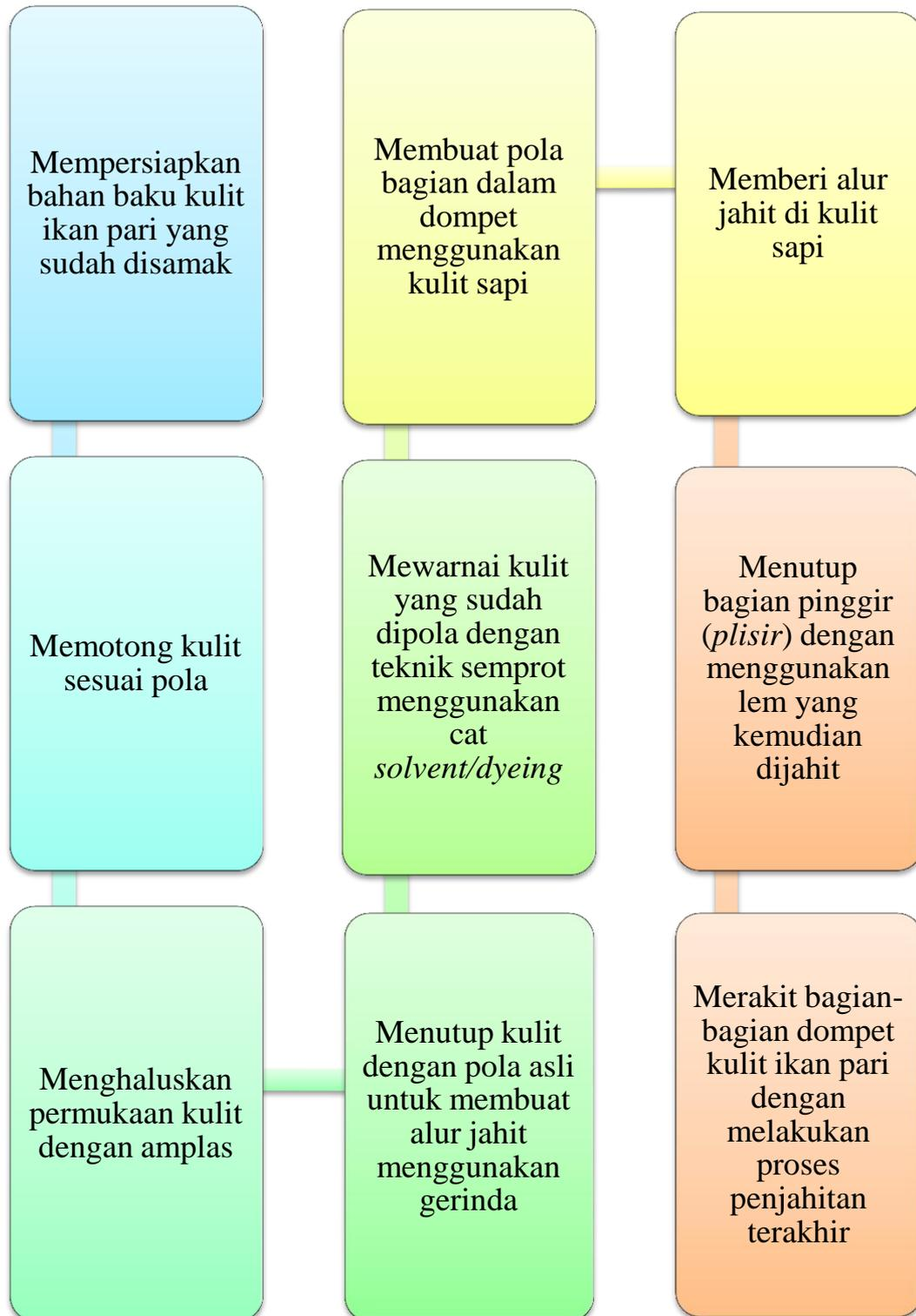
Gambar 17. Proses Pembuatan Dompet pada UKM “Pari Radja”
