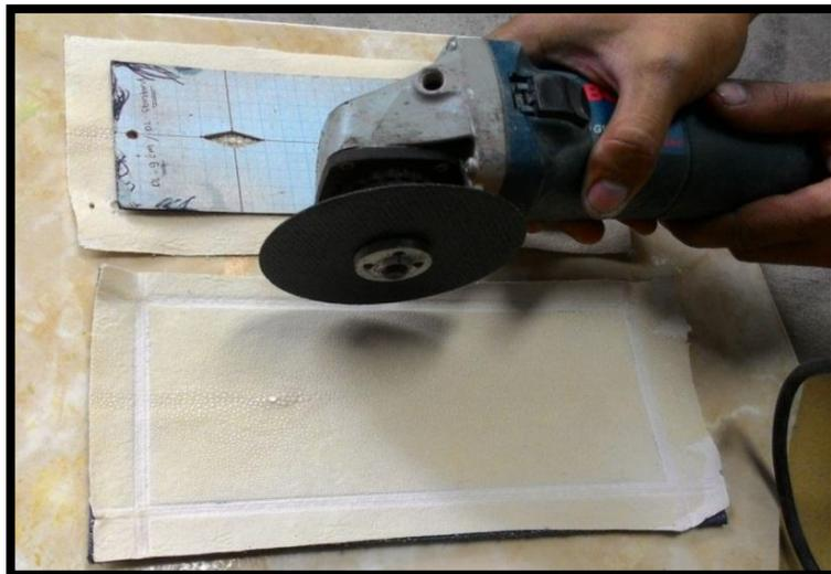
**Gambar 12: Proses Gerinda/Pembuatan Alur Jahit**
