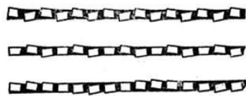
Gambar 14. Bentuk Gigi Gergaji Silang
