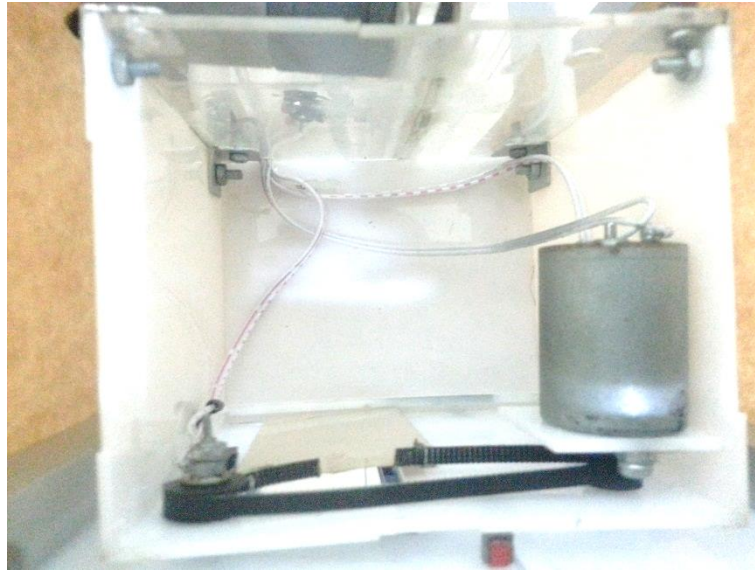
Gambar 34. Mekanik Buka-Tutup Pintu Rumah Lift
