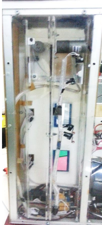
Gambar 33. Mekanik Naik-Turun Rumah Lift
