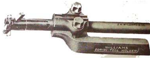
Gambar 23. Toolholder pembesaran lubang sedang
