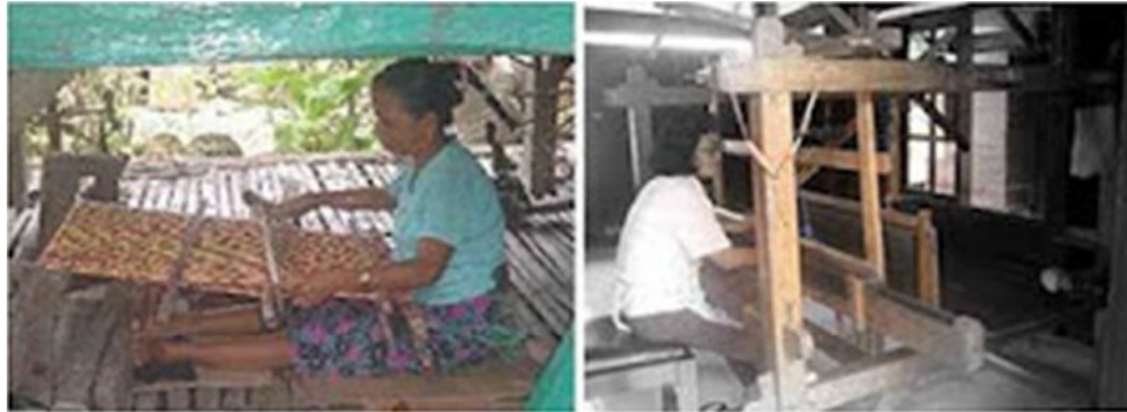
ATBM yang digunakan dengan duduk dilantai (kiri); ATBM yang digunakan dengan duduk di bangku (kanan)
