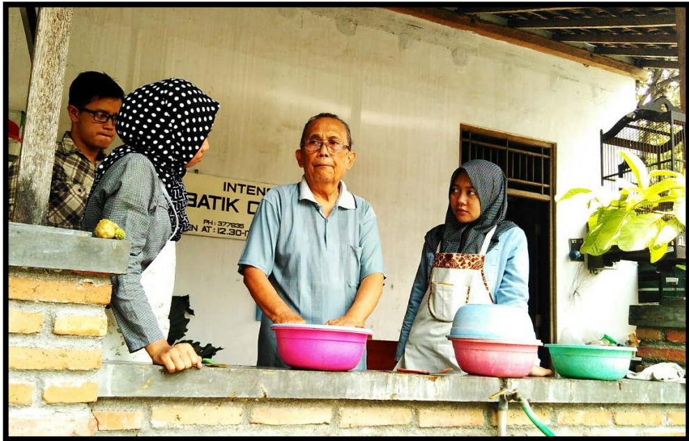
Gambar XXVI: Proses Mencelupkan Kain Pada Larutan Naphthol (Sumber: Dokumentasi Rahmawati, April 2016)
