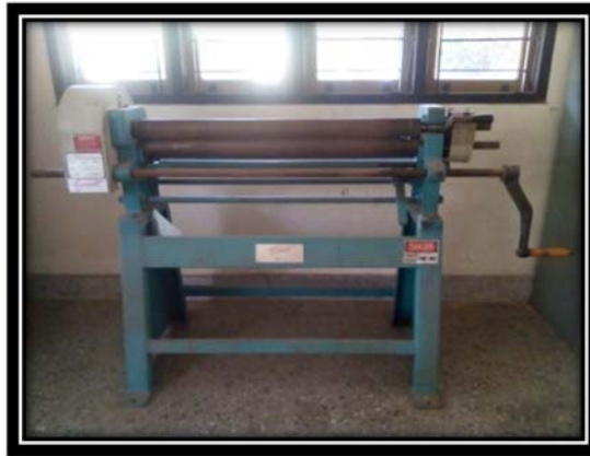
Gambar XXXIX: Mesin Pembulat (Sumber : Dokumentasi Penulis/ Januari 2016)
