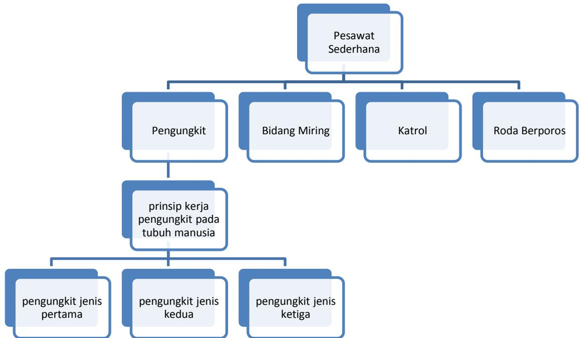
Pesawat Sederhana adalah alat yang digunakan manusia untuk mempermudah dalam melakukan usaha yang bentuknya sangat sederhana. Contoh dari pesawat sederhana adalah pengungkit atau tuas, bidang miring, dan katrol serta roda dan poros yang merupakan beberapa jenis pesawat sederhana yang sering digunakan sehari-hari.
