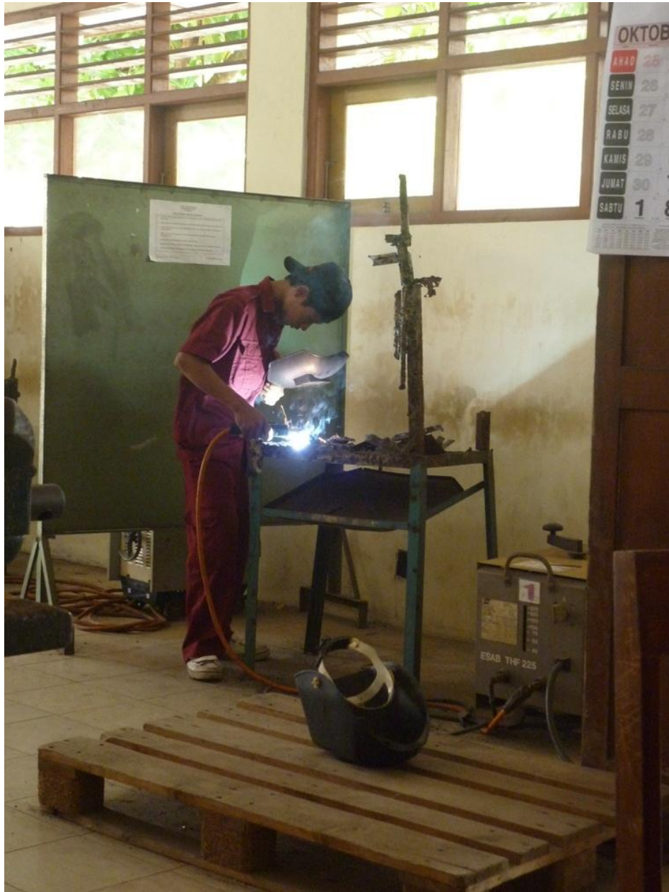
Foto 9. Seorang siswa sedang melakukan pengelasan dengan Las Busur Manual
