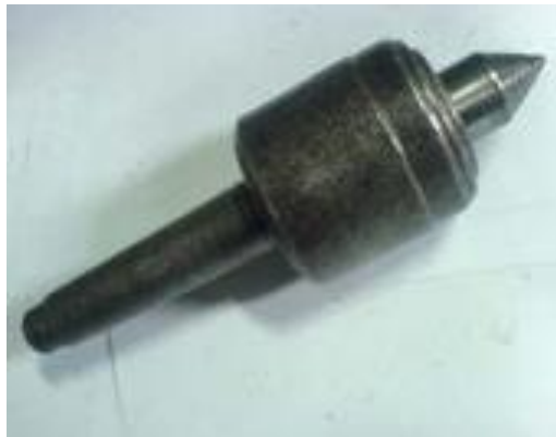
Gambar 10. Senter Putar (Bengkel Mesin UNY, 2010)
