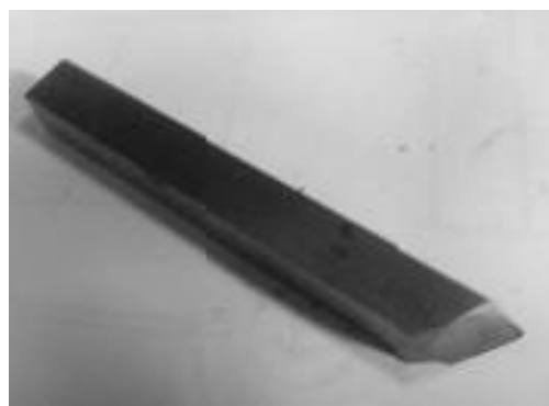
Gambar 7. Pahat bubut rata kanan (Bengkel Mesin UNY, 2010)
