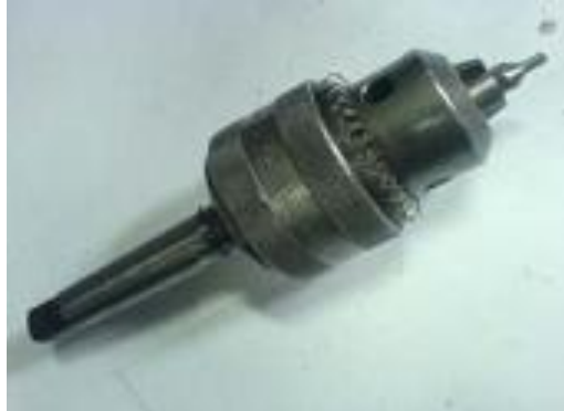
Gambar 9. Bor senter (Bengkel Mesin UNY, 2010)
