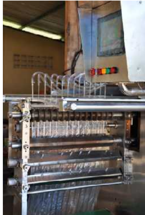
Gambar 18. Multi Lines Packaging Machines untuk Bumbu Bubuk
