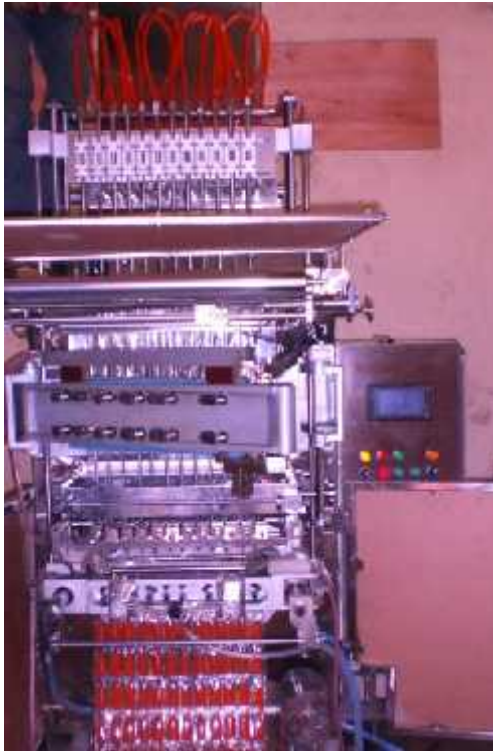
Gambar 17. Multi Lines Packaging Machines untuk Saos
