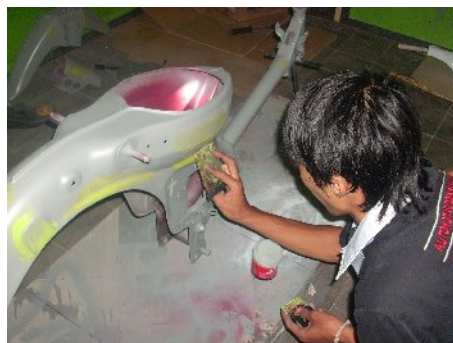
Gambar 18. Pendempulan bodi kendaraan yang mengalami kerusakan
