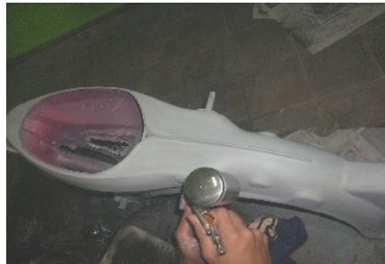
Gambar 20. Proses aplikasi epoxy
