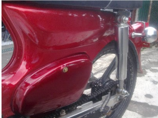
Gambar 25. Hasil perbaikan pada bodi sebelah kiri
