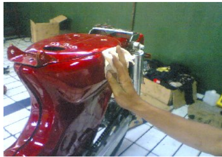
Gambar 24. Proses pengkilapan dan pemolesan
