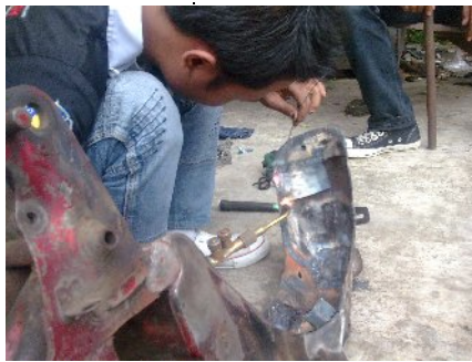
Gambar 16. Pengelasan bodi kendaraan yang mengalami kerusakan
