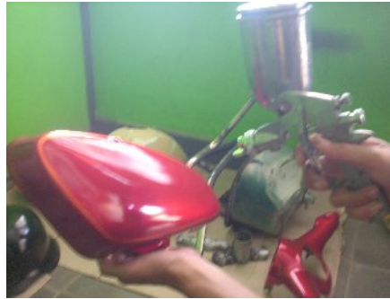
Gambar 22. Proses pengecatan top coat
