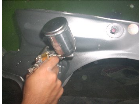
Gambar 21. Proses pengecatan cat dasar
