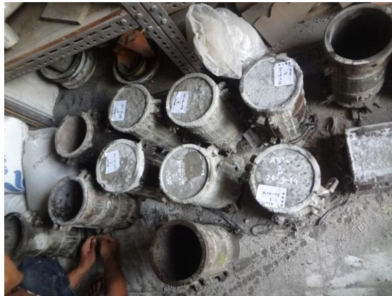
Foto 5. Proses pengerasan beton selama 24 jam
