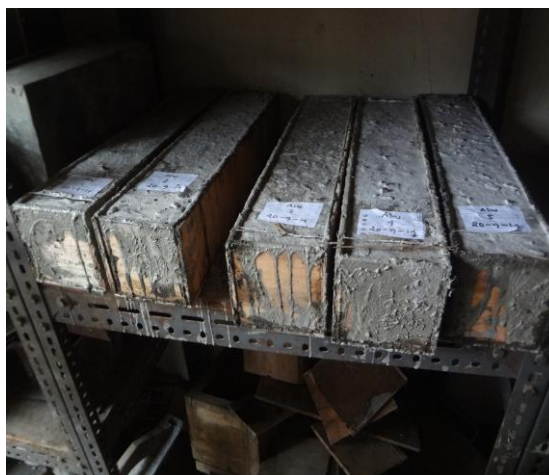
Foto 6. Proses pengerasan beton selama 24 jam
