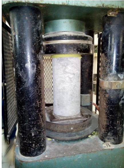
Foto 7. Pengujian kuat tekan beton
