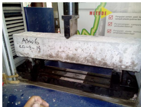
Foto 9. Pengujian kuat lentur beton
