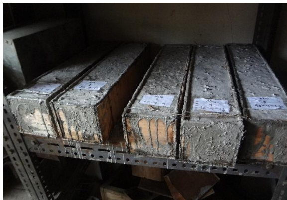
Gambar 56. Penyusutan Benda Uji Beton Saat Umur Perawatan
