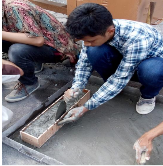
Foto 4. Proses masukan beton kedalam cetakan balok
