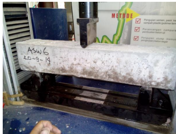
Foto14. Pengujian kuat Lentur beton umur 14 hari
