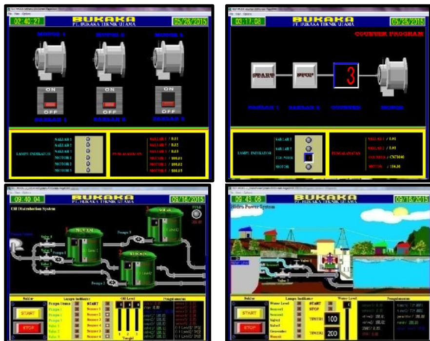
Gambar 9. Desain Simulator Aplikasi PLC
