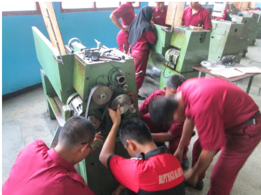
Foto 2. Siswa mengatur mesin untuk membuat ulir
