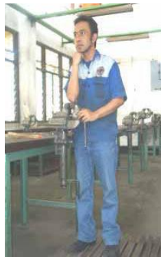
Gambar1. Ketinggian ragum untuk pengerjaan umum kerja bangku
