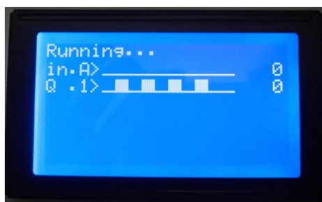
Gambar 55. Signal Clock pada Display Logic Analyzer
