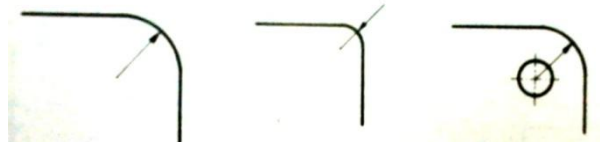
Gambar 24. Penempatan Ukuran Pada Jari-Jari Benda (Sumber: Sirod dan Parjono, 1983:34)
