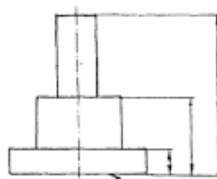
Gambar 23. Penempatan Ukuran Secara Tegak atau Vertikal (Sumber: Sirod dan Parjono, 1983:34)
