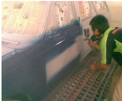
Gambar 31. Proses pengecatan cat dasar
