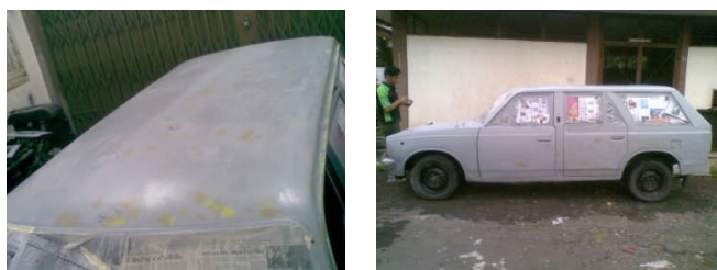
Gambar 30. Proses aplikasi epoxy
