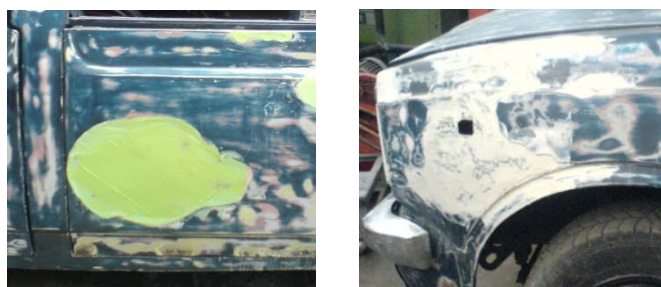
Gambar 29. Pendempulan bodi kendaraan yang mengalami kerusakan
