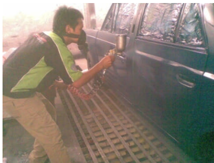
Gambar 32. Proses pengecatan top coat
