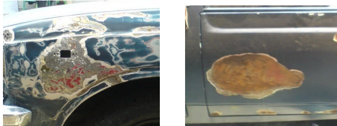
Gambar 28. Mengupas lapisan cat pada bodi yang rusak
