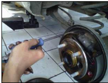
Gambar 9. Pemeriksaan kemacetan piston rem
