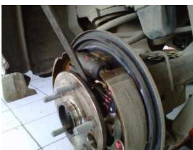
Gambar. 54 Penyetelan kanvas rem
