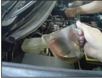
Gambar. 24 Mengisi minyak rem
