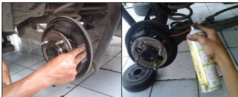
Gambar. 52 Pengamplasan dan penyemprotan break cleaner pada tromol
