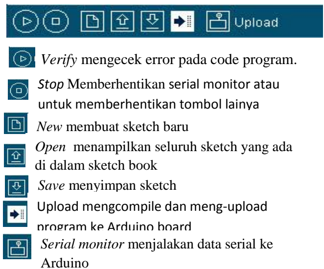
Gambar 8. Fungsi toolbar Arduino IDE
