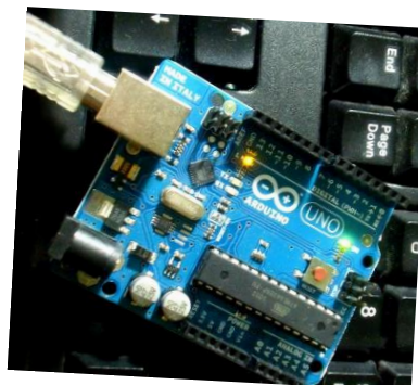
Gambar 11. LED Indikator pada Arduino menyala saat dihubungkan ke laptop/ PC
