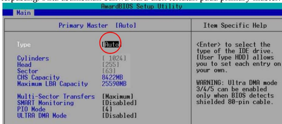
Gambar 2. Penentuan Hard Disk dan CD-ROM pada BIOS
