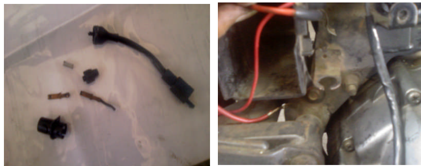
Gambar 50. Switch Rem Belakang Pecah/rusak dan Selum Pemasangan Switch Rem
