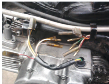
Gambar 39. Sebelum Penyambungan Kabel-kabel Sistem Pengapian
