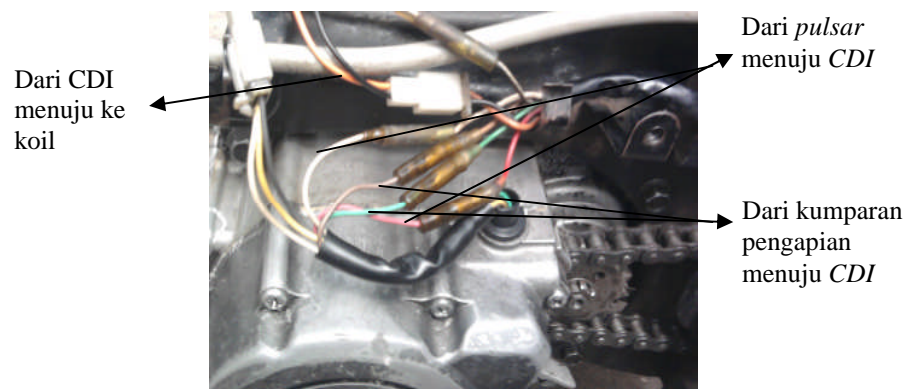
Gambar 40. Sesudah Penyambungan Kabel-kabel Pengapian
