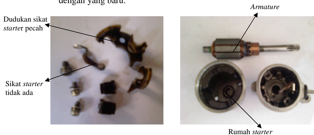
Gambar 31. Dudukan Sikat Starter Pecah dan Sebelum Pemasangan Sikat Starter
