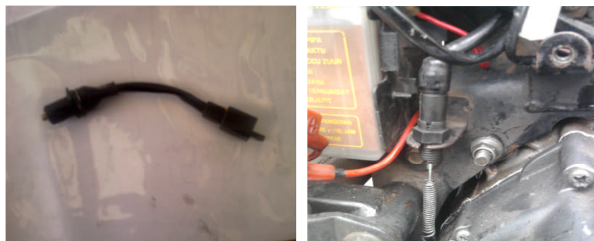
Gambar 51. Switch Rem Belakang Baru dan Setelah Pemasangan Switch Rem
