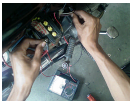
Gambar 42. Pengukuran Arus Pengisian Baterai
