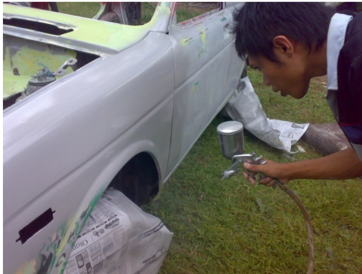
Gambar 59. Proses pengecatan dasar
