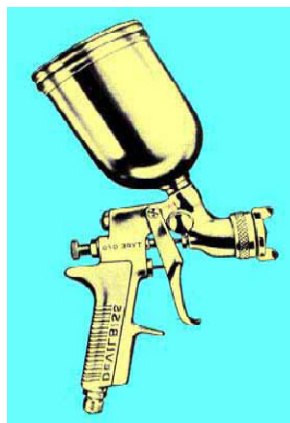
Gambar 15. Spray Gun tipe umpan balik (sumber http://crayonpedia.org/mw/Berkas:Gun_175.jpg )
