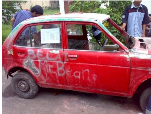
Gambar 56. Pengelupasan lapisan dempul dan cat
