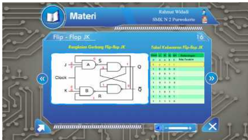
Gambar 38. Tampilan Animasi Cara Kerja Flip-flop JK Dengan Tambahan Masukan Clock
