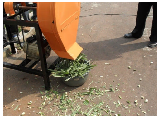
Rajangan rumput gajah yang keluar dari mesin
