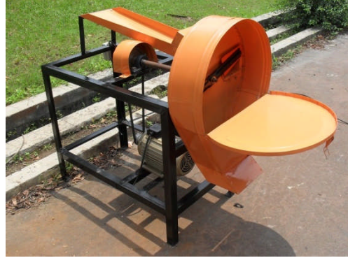
Mesin perajang hijauan tampak samping
