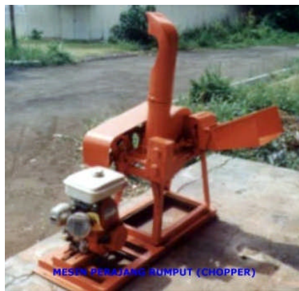
Gambar 2. Contoh Mesin Perajang Hijauan yang Sudah Ada
