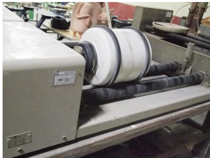
Gambar LXXII: Penggilingan Bahan Glasir (Sumber: Dokumentasi Anwar, Maret 2016)
