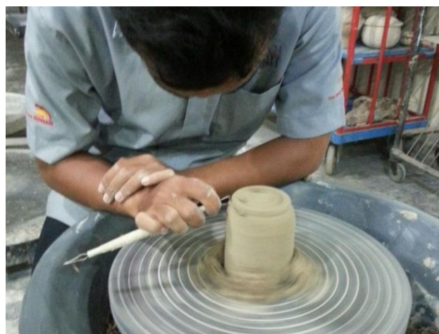
Gambar LXII: Triming (Sumber: Dokumentasi Anwar, Februari 2016)
