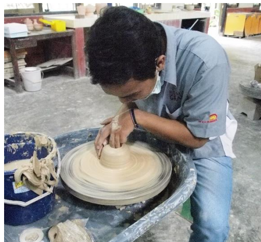
Gambar LXI: Pembentukan Benda dengan Teknik Putar (Sumber: Dokumentasi Anwar, Februrari 2016)
