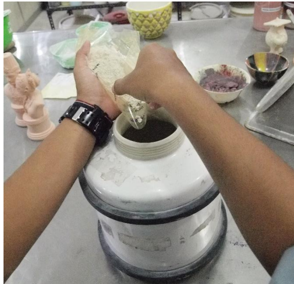
Gambar LXXI: Pencampuran Bahan Glasir (Sumber: Dokumentasi Anwar, Maret 2016)
