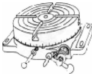
Gambar 3.28. Meja putar pengerjaan meja putar biasanya ditambahkan dengan clamp dan center pin untuk mencekam benda kerja. Pembagian jarak antar gigi pada meja putar dapat dicari dengan persamaan sebagai berikut:
