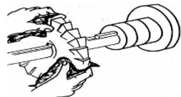
Gambar 3.43. Memasang pisau frais
