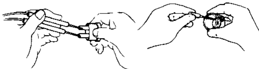
Gambar 20. Pengukuran dan Pengesetan Ulang Pemutus Rangkaian
