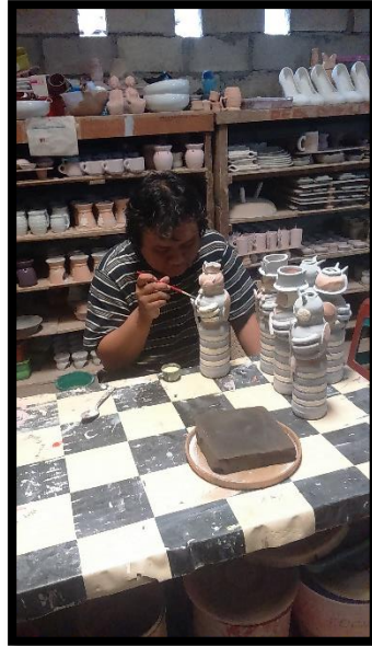
Gambar 83. Proses glasir dengan cara mengkuas permukaan karya (Dokumentasi: Slamet Riyadi. November 2015)
