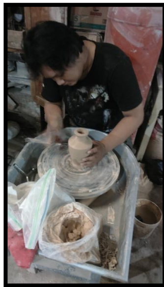
Gambar 74. Proses dekorasi menggunakan alat putar (Dokumentasi: Slamet Riyadi. September 2015)
