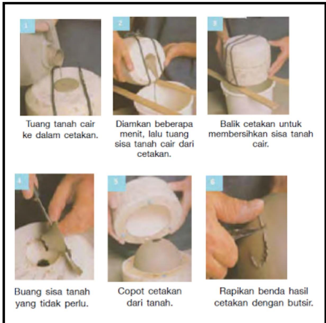
Gambar 9. Contoh penggunaan teknik cetak tuang (Sumber: www.myarcive.blogspot.co.id )
