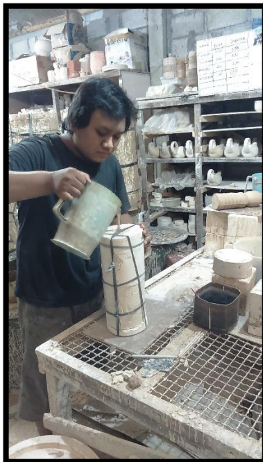
Gambar 72. Menuang tanah cair ke dalam cetakan (Dokumentasi: Slamet Riyadi. September 2015)
