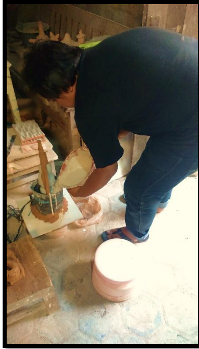
Gambar 71. Menuang gypsum dalam pembuatan cetakan (Dokumentasi: Slamet Riyadi. September 2015)
