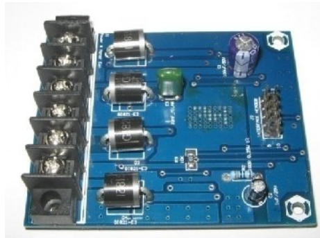
Gambar 3. Penggerak Motor 5 A dengan IC (Sumber: e-manual EMS 5A, 2013: 1)
