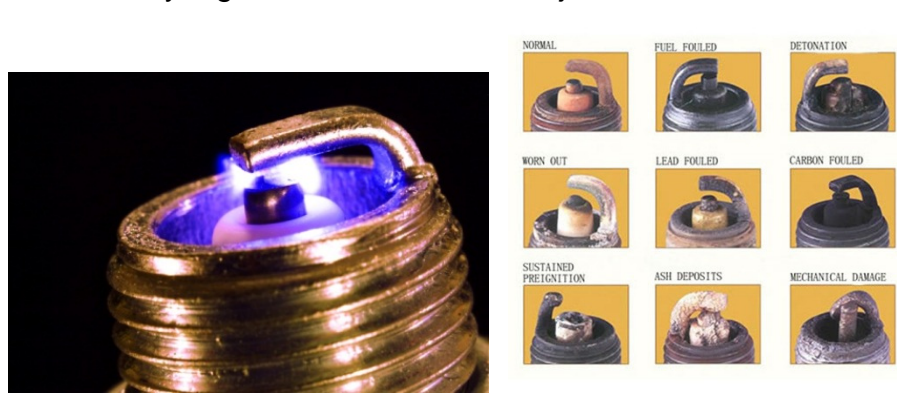
Gambar 5. Busi memercikkan bunga api berwarna biru(kiri) busi yang normal mengindikasikan pembakaran yang bagus, ini ditandai dengan warna elektroda yakni “merah bata” (kanan-gambar atas pojok kiri).
