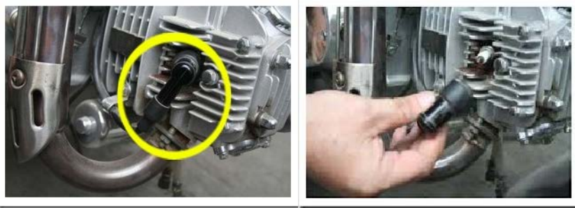
Gambar 4. Mencabut tegangan tinggi pada kabel busi.
