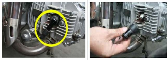
Gambar 3. Mencabut tegangan tinggi pada kabel busi. Sumber: www.citizenjournalism.com .
