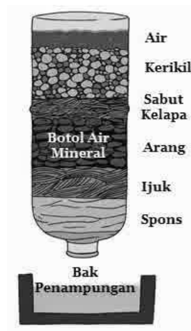
Gambar 2. Filtrasi Air secara Sederhana Sumber : Nanang Ajim (2014)
